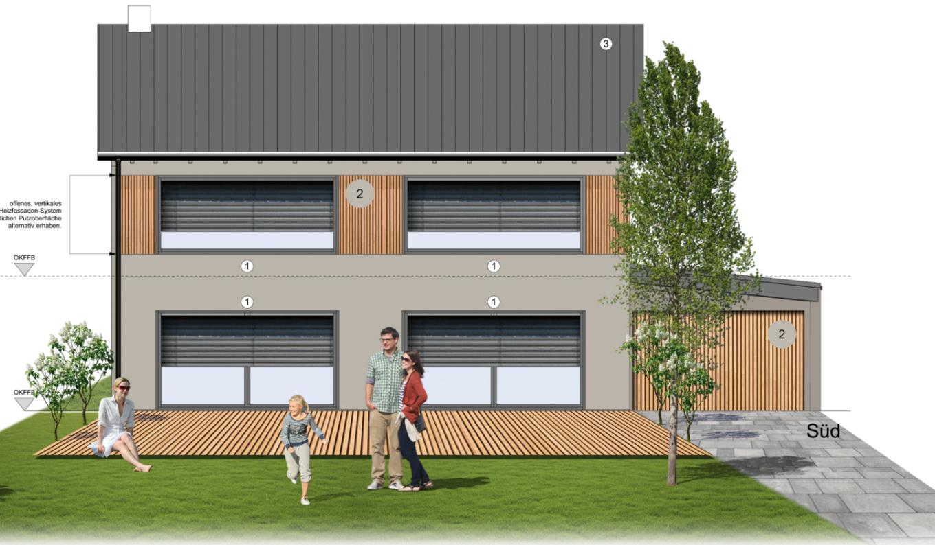
DACH, GLATZIEGEL Z.B. ALTFARBEN BASALT O. ALTERNATIV STEHFALZ PANEEL ALU MATT
